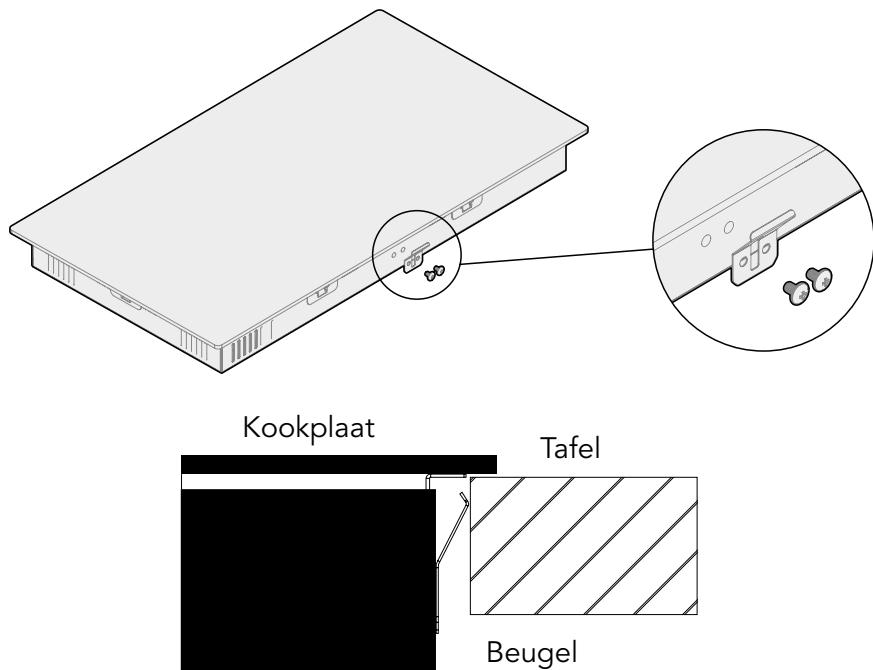
**⚠️** Onder geen beding mogen de beugels na installatie de binnenoppervlakken van het werkblad raken (zie afbeelding).
