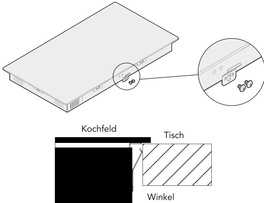
**⚠** Unter keinen Umständen dürfen die Winkel nach der Installation die inneren Oberflächen der Arbeitsplatte berühren (siehe Abbildung).
