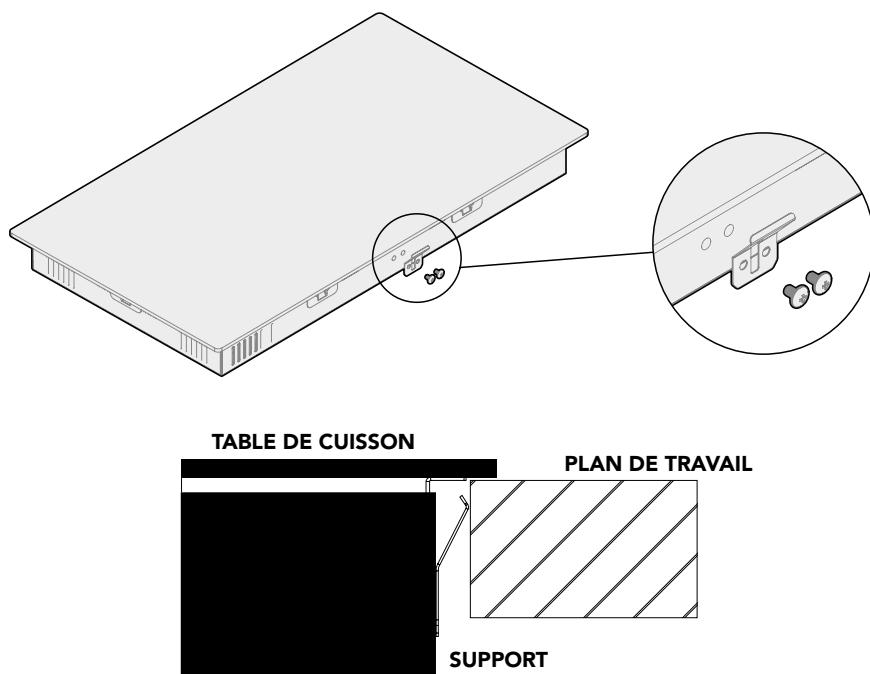
**⚠️ Attention :** Après l'installation, il est impératif de vérifier que les supports de la table de cuisson ne sont en aucun cas en contact avec les surfaces intérieures du plan de travail, comme illustré dans l'image fournie.
