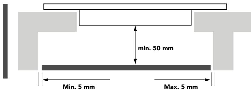
**!** Es befinden sich Lüftungslöcher rund um das Kochfeld. SIE MÜSSEN sicherstellen, dass diese Löcher nicht von der Arbeitsplatte blockiert werden, wenn Sie das Kochfeld einbauen.
