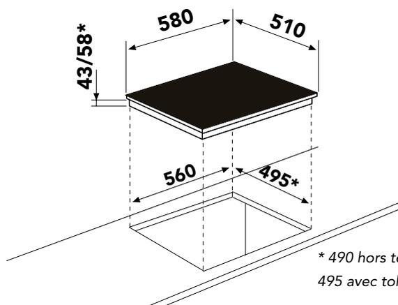
\* 490 hors tête de vis / 494 sans tolérance montage mécanique /
